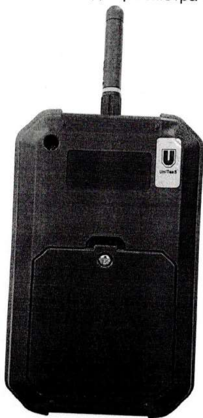
Рисунок 2. Место пломбирования термометра UniTesS THB 2 от несанкционированного доступа
